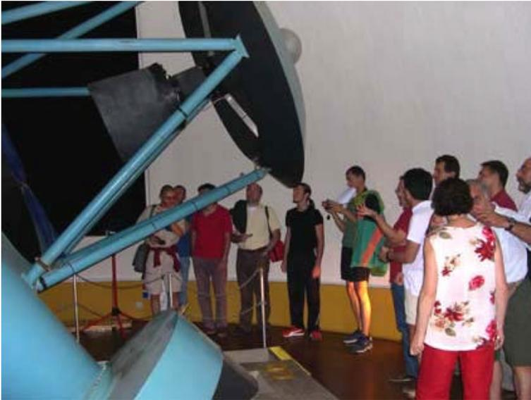
Il telescopio è montato su due piloni che partono direttamente dal piano terra e sono separati dalla struttura dell'osservatorio per ridurre la trasmissione di oscillazioni anche in caso di terremoto. L'ultima scossa sismica ha portato all'oscillazione del telescopio per alcuni secondi senza neanche perdere la guida ci ha raccontato Antonio.
